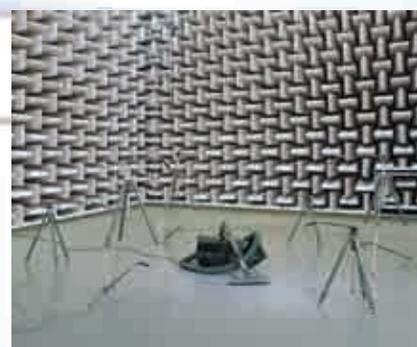
1. Определение мощности шума на основе измерения создаваемого источником звукового давления в свободном (или приблизительно свободном) пространстве.
