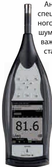
Анализатор 2250 Light был разработан специально для измерения производственного, окружающего и эксплуатационного шума, полностью отвечая требованиям всех важных государственных и международных стандартов.
