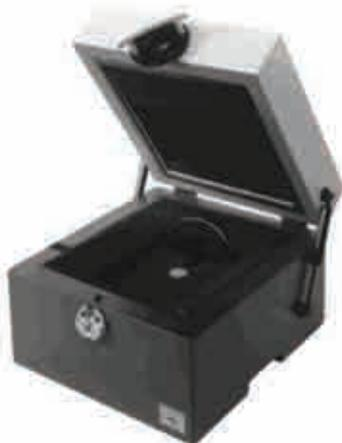
В идеальном случае безэховая тестовая камера предназначена для двух основных целей – создание точного акустического воспроизведения входного электрического сигнала и исключение влияния любых внешних шумов. Безэховая тестовая камера модели 4232 по своим параметрам очень близка к идеальной и
