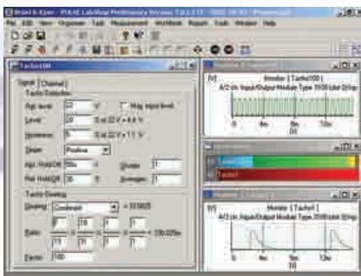
Выбор разнообразных настроек выделения тахосигнала для его точного выделения из импульсов таходатчика. Поддерживается анализ нескольких тахосигналов и анализ гармоник с использованием нескольких опорных сигналов. Функция Autotracking™ извлекает тахосигнал из входных данных измерений.
