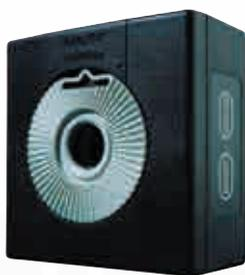
Это ручной, портативный источник звука для калибровки измерителей уровня звука и другого звукового измерительного оборудования.
