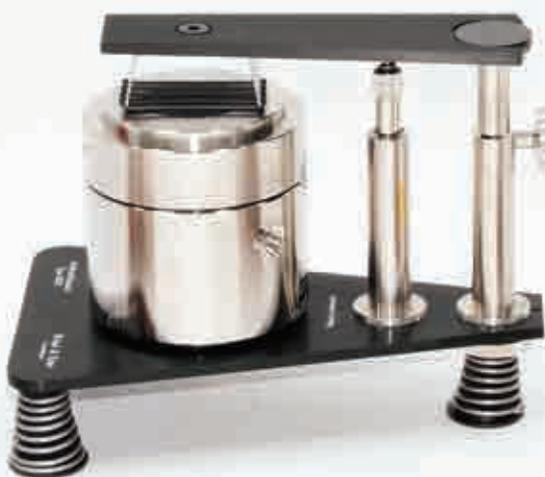
расположено в подвешенном покоящемся положении на трех конических пружинах с вмонтированными уплотнителями из пористой резины, предназначенными для демпфирования. Собственные частоты конструкции, изолированной таким образом от внешних воздействий, таких как некоторые сотрясения стола во время работы прибора, не превышают значения 5 Гц, что в десять раз меньше нижней предельной частоты рабочего диапазона.
