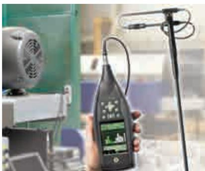
Прибор 2270-G – это законченная система измерения звука, состоящая из ручного анализатора модели 2270, ПО измерения интенсивности звука, а также набора датчиков для измерения интенсивности звука 3654. Портативность и работа от аккумуляторов упрощает измерение.
