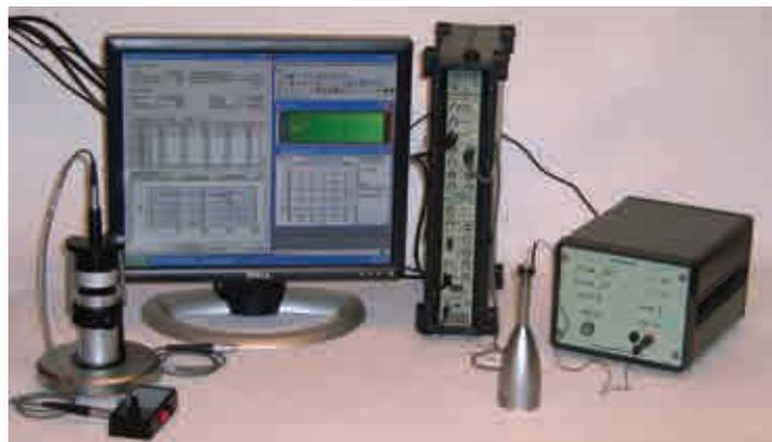
Конструкция системы позволяет с использованием электростатического актюатора измерять не только абсолютные значения характеристик, но также и фазовые характеристики микрофона. Эти средства позволяют сравнивать характеристики микрофонов с использованием актюатора, но не измерять абсолютные фазовые характеристики, поскольку погрешности таких измерений не были проанализированы и документированы.
