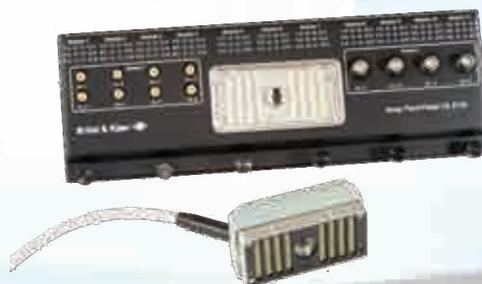
Предназначена для использования с переносными микрофонными решетками совместно с шасси LAN-XI типа 3660-D.
