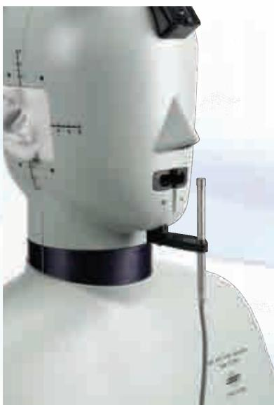
Имитатор головы и торса 4128 предназначен для осуществляемых на месте эксплуатации исследований и объективной оценки параметров телефонов, наушников, микрофонов, головных телефонов, звукоусилительных устройств, слуховых аппаратов, средств защиты слуха и др. Прибор 4128 находит применение также
