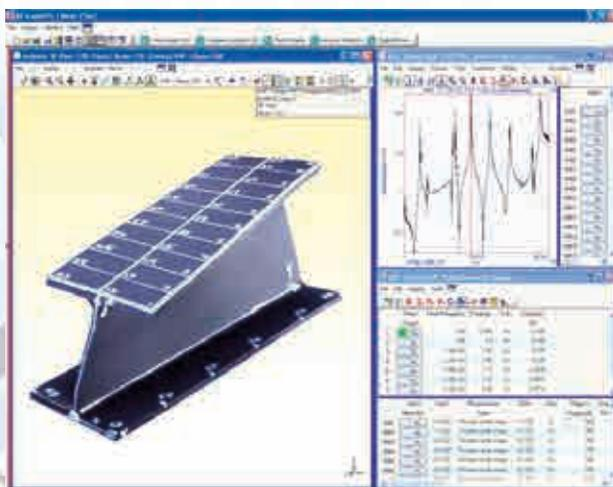
FRF (АЧХ) можно отобразить с анимацией непосредственно в MTC. Получение модальных параметров может быть выполнено в пакете последующей обработки, например, ME'scopeVESTM, отображение анимированных форм мод отличается фотографической реалистичностью.
