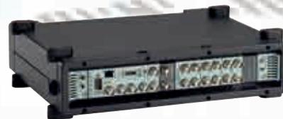
**3560D МНОГОКАНАЛЬНАЯ ПОРТАТИВНАЯ СИСТЕМА PULSE**
