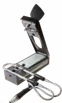
ИнтенСИОМЕТРИЧЕСКИЙ калибратор типа 4297 применяется для калибровки датчиков звукового давления и проверки коэффициента остаточного давления на месте работы, при этом для выполнения калибровки он не требует разборки датчика интенсивности звука. По фазовому сдвигу калибратор оптимизирован для работы с системой измерения интенсивности звука 2270, одна-
