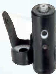
Калибратор типа 4294 позволяет точно откалибровать измерительный прибор при стандартном ускорении, равном 10 м/сек<sup>2</sup> (нагрузка от 0 до 70 г). Эталонный сигнал можно также использовать для калибровки скорости и смещения, равных 3.16 мм/сек и 3.16 мкм, соответственно.
