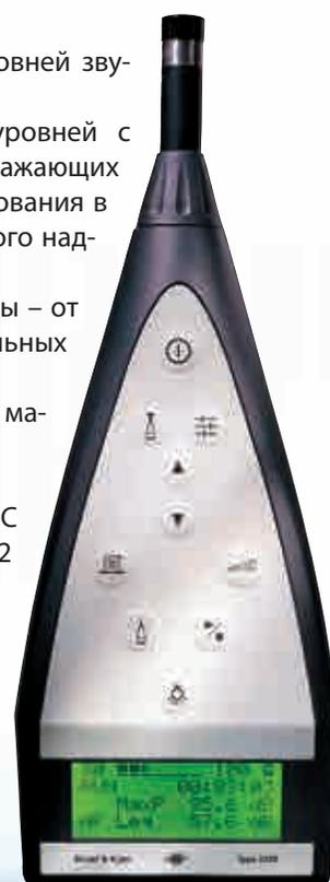
**2239B – ИНТЕГРИРУЮЩИЙ ШУМОМЕР – ВИБРОМЕТР****Основные характеристики и измеряемые параметры:**
