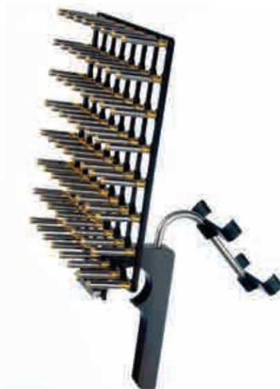
на автоматизированная система позиционирования микрофонов (сканирующее устройство) для автоматических измерений в объеме, окружающем крупные источники.
