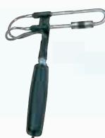
**3595** – Интенсиметрический зонд, предназначенный для работы с двухканальным анализатором спектра типа 2270. В зонде применяется согласованная микрофонная пара типа 4197, позволяющая проводить измерение интенсивности звука в диапазоне частот от 20Hz Гц 6,3кГц.
