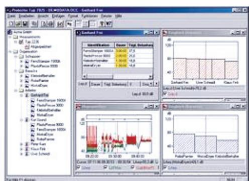
Protector™ – это программный пакет на основе системы Windows, предназначенный для постобработки, моделирования и архивирования данных о воздействии шума. Эта программа разработана для применения с семейством измерителей уровня звука компании Brüel & Kjær, дозиметрами шума и анализаторами уровня звука. ПО Protector позволяет быстро загружать профили образцов шума из различных мест или от разных людей. Программа Protector дает возможность исполь-
