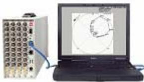
Это универсальное высококачественное программное обеспечение помогает инженерам по диагностике машин и механизмов принимать быстрые и точные решения. Турбо-система сбора данных работает в составе программного обеспечения для анализа вибрации машин/динамики роторных систем. Программное обеспечение SignalCalc® позволяет вести сбор данных как в установившемся, так и в переходном (запуск/останов) состояниях, а также использовать для отображения данных различные графики, в частности:
