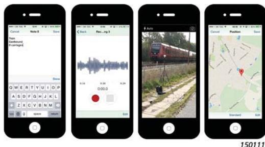
Как только подключение к анализатору будет выполнено, пользователь может начать, прекратить или поставить измерение на паузу дистанционно. В процессе измерения шума на экране приложения показан мгновенный профиль величины  $L_{AF}$ .
