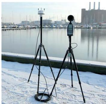
Погодные условия влияют на распространение звука, например, при измерении шума окружающего пространства можно учесть скорость и направление ветра. Следовательно, большинство стандартов, касающихся измерения шума окружающей среды, определяют пределы для скорости и направления ветра. Чтобы убедиться, что выполненное измерение укладывается в пределы допуска по скорости и направлению ветра, необходимо использовать набор метеостанции MM-0316-A (два параметра) или MM-0256-A (шесть параметров).
