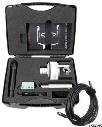
Метеостанции работают на базе ультразвуковой технологии, частота которой лежит выше верхней предельной частоты микрофона. Необходимо подключить метеостанцию к анализатору и включить ее, после чего оборудование будет готово к измерению без каких-либо настроек. Метеостанция работает от аккумулятора анализатора, поэтому не нуждается в дополнительных элементах питания.
