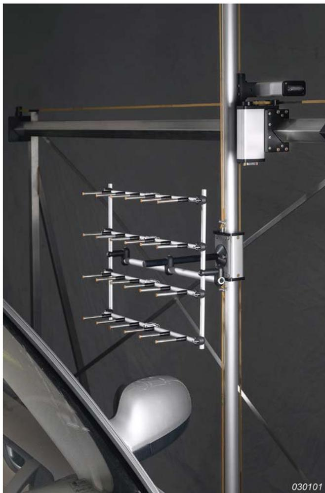
Конфигурация типовой измерительной системы включает в себя двухосевую систему (ось X и Y), позволяющую выполнять измерение в одной плоскости. В эту систему может быть установлен как отдельный датчик, так и решетка датчиков и преобразователей. Система позиционирования может быть установлена на колеса и легко перемещена в нужное место для измерения. Это позволяет выполнять измерение в полуавтоматическом режиме вокруг объекта, если перемещать ее вручную между поверхностями.
