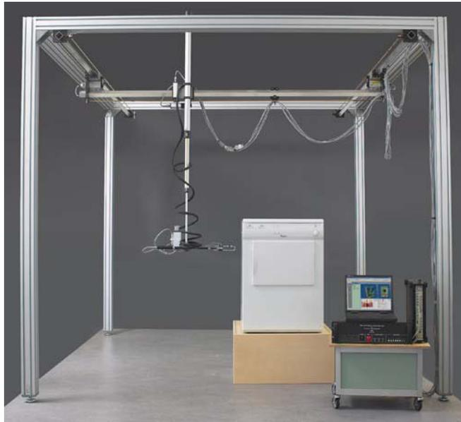
Полностью автоматическая система, как правило, роботизирована в пяти направлениях и состоит из отдельных микрофонов, датчиков интенсивности или небольших решеток.
