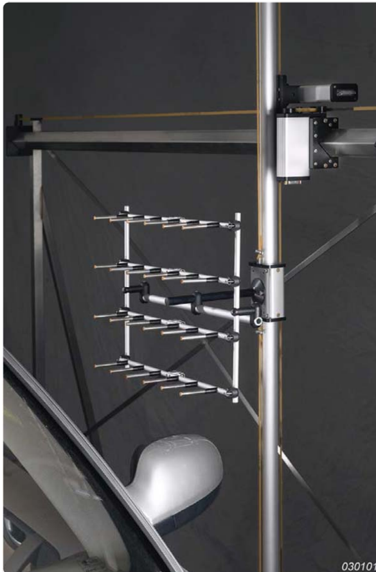
Рис. 4. Двухосевая роботизированная система позиционирования микрофонов с установленной микрофонной решеткой 6 x 4, предназначенной для STSF-измерений.
