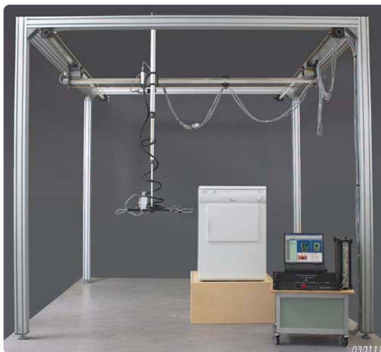
Рис. 5. 5-осевая роботизированная система с датчиком измерения интенсивности звука.
