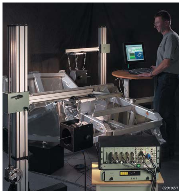
Рис. 11. Применение анализа MIMO- систем с использованием нескольких вибраторов и акселерометров.
