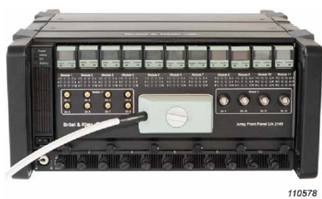
Рис. 39. Слева: панель UA-2145-D, установленная в стойку 3660-D с одиннадцатью 12-канальными модулями 3053-B-120, Справа: двуслойная портативная решетка 8 x 8
