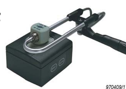
Рис. 10. Калибровка звукового давления при помощи звукового калибратора 4231.
