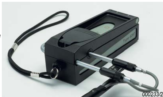
Рис. 9. Выполнение полной калибровки при помощи калибратора интенсивности звука 4297.
