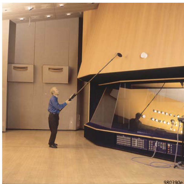
Рис. 14. Построение карты ослабления звука с целью снижения проникновения звука из студийного помещения в режиссерскую комнату.
