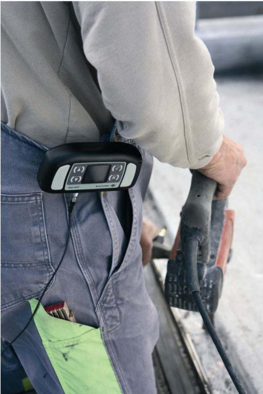
*Измерения вибрации верхних конечностей должны проводиться при нормальном использовании исследуемого объекта. Датчик вибраций устанавливается на объект, и измерения проводятся при помощи прочного переносного прибора.*
