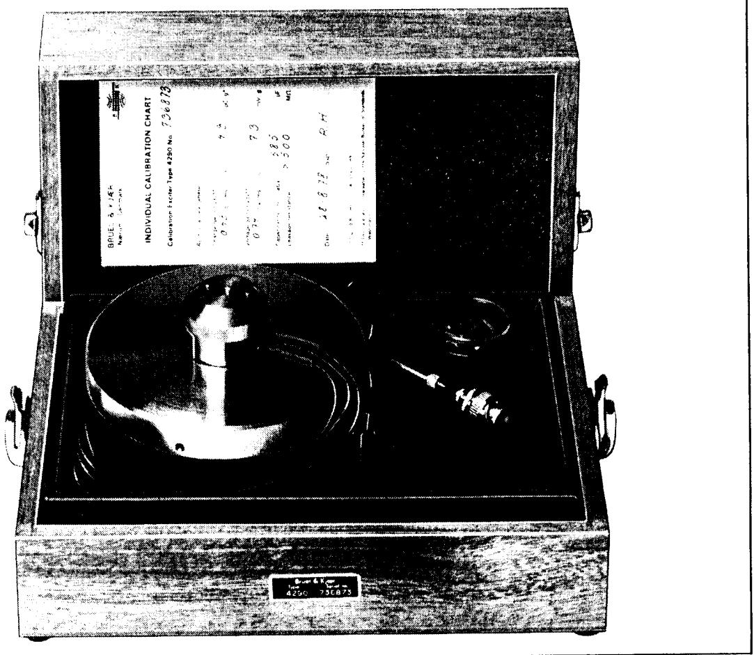
Рис. 5.14. Калибровочный вибростенд 4290 фирмы Брюль и Кьер
