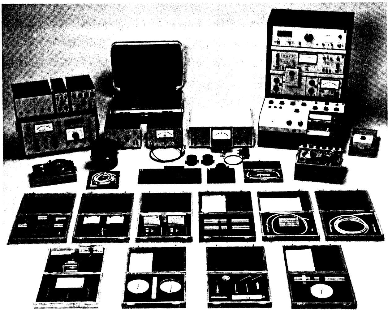
Рис. 5.17. Калибровочная система 9559 фирмы Брюль и Къер
