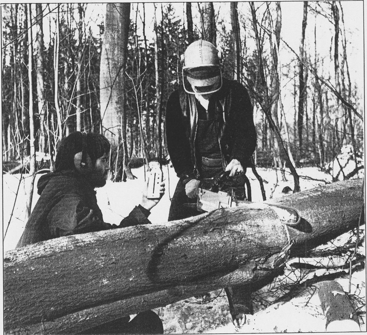
Рис. 1.4. Осуществляемые с помощью портативного виброметра и акселерометра исследования механических колебаний, передаваемых через рукоятку цепной пилы
