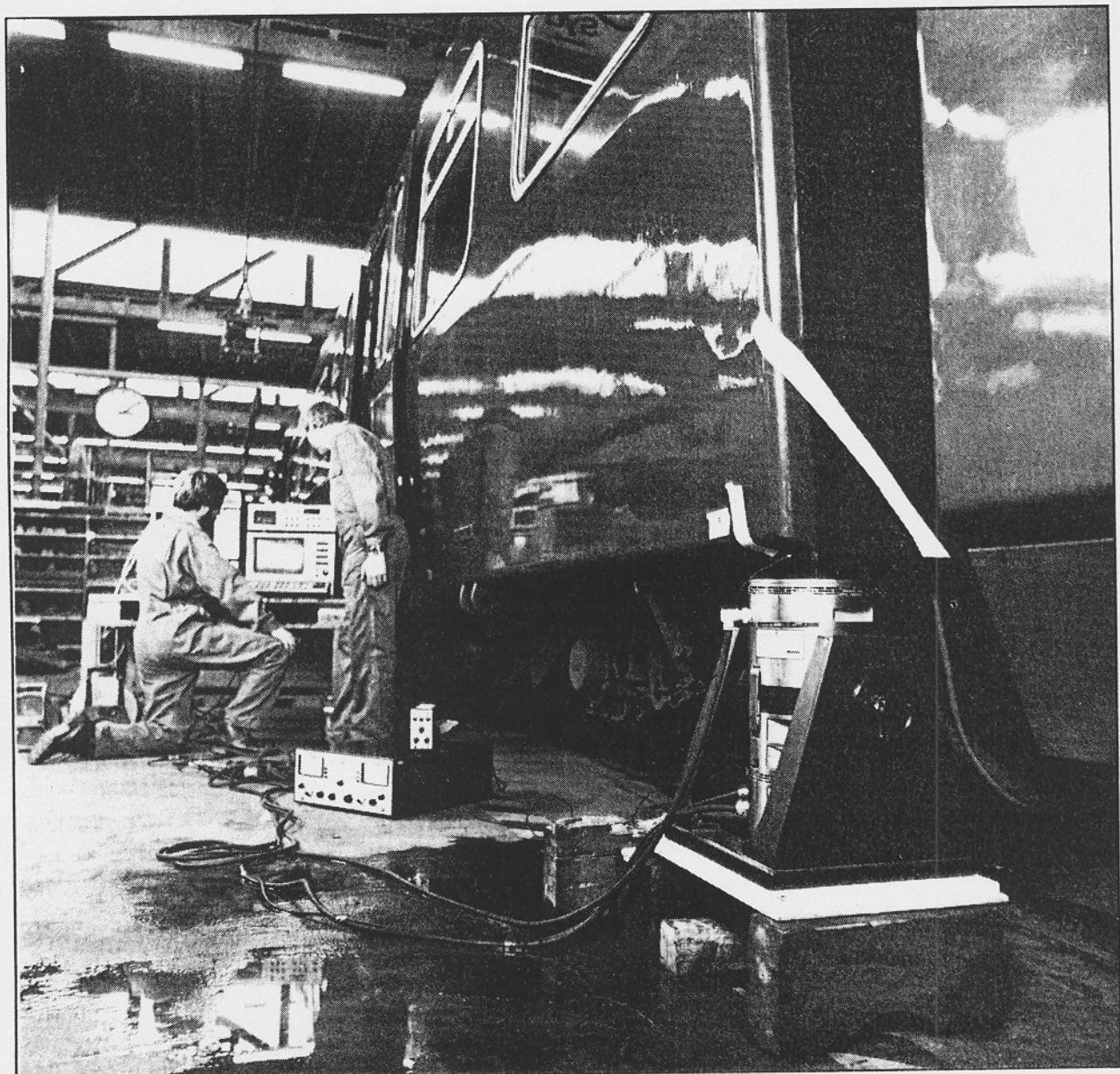
Рис. 1.3. Исследования динамических характеристик и мод колебаний железнодорожного вагона с применением виброиспытательной аппаратуры
