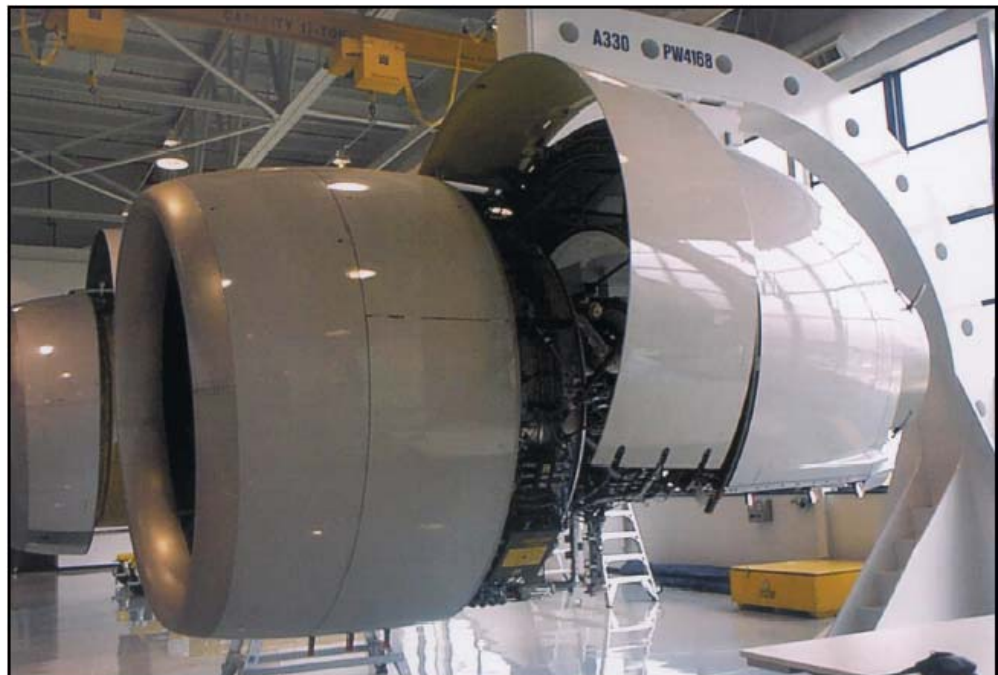
Рис.1 Мотогондola для одного из двигателей "Пратт&Уитни" PW4168 для самолета "Эйрбас" A330
