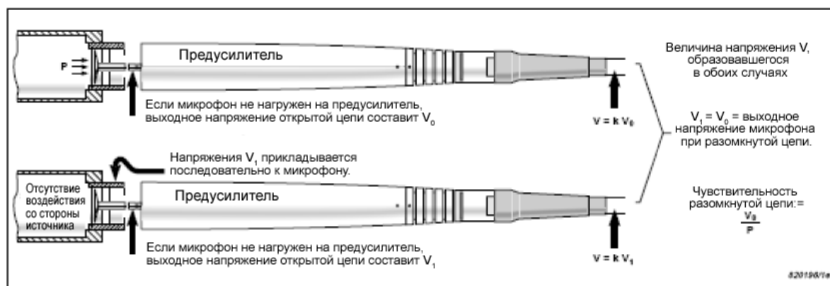
Рисунок 6.4. Принцип калибровки методом инъекции напряжения.
