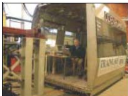
Рис. 9 Вибрационные исследования фрагмента железнодорожного вагона с применением PULSE
