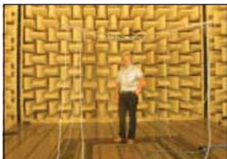
Рис. 3 Измерение силы звука с помощью ручного пневматического приспособления в полубезэховой камере
