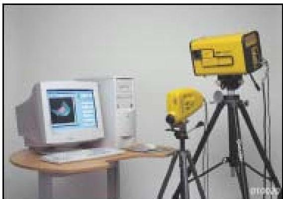
Рис. 5. Лазерные доплеровские виброметры
