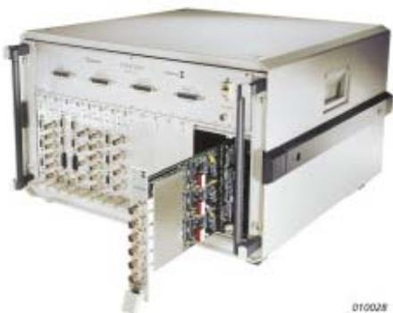
Рис. 11. Для крупномасштабных, многоканальных модальных тестов с сотнями вибрационных преобразователей система OASIS обеспечивает подачу энергии и согласование сигнала ко всем типам акселерометров в компактной и удобной форме
