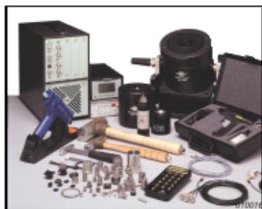
Рис. 3. Внимательно относясь ко всем деталям применения модального тестирования, мы разработали полный комплект оборудования, требуемого для получения успешных результатов
