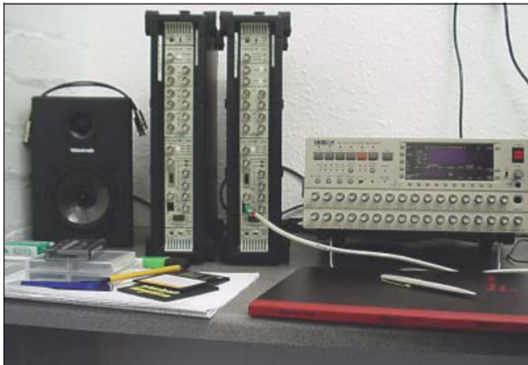
Рис. 2 Два интерфейса PULSE и 16-канальный регистратор данных TEAC DAT
