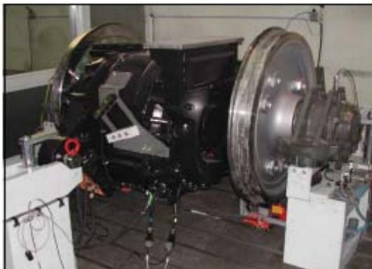
Измерения на обоих стендах проводятся при помощи системы сбора данных PULSE 3560 D. Поэтому, пока на одном стенде выполняется тестирование, на втором готовят следующее шасси.
