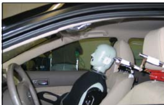
Рис. 4 Манекен (голова и туловище) Brüel & Kjær Head and Torso Simulator Type 4128C (HATS) располагается на переднем пассажирском сидении, и проводит двухканальные измерения шума в кабине. Дополнительные микрофоны располагаются в кабине
