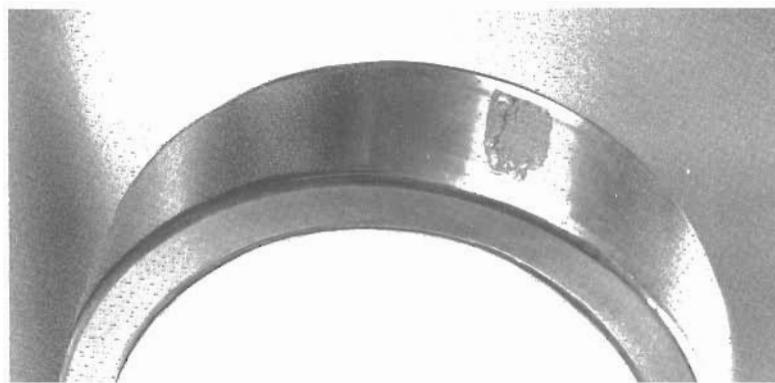
Рис. 20. Роликовый подшипник с дефектом, снятый с эксплуатации через пять месяцев после первого признака дефекта
