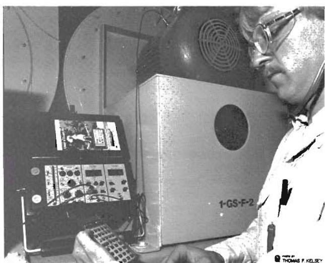
Рис. 6. Применение портативного балансировочного комплекта 3537 при балансировке вентилятора парового сальника
