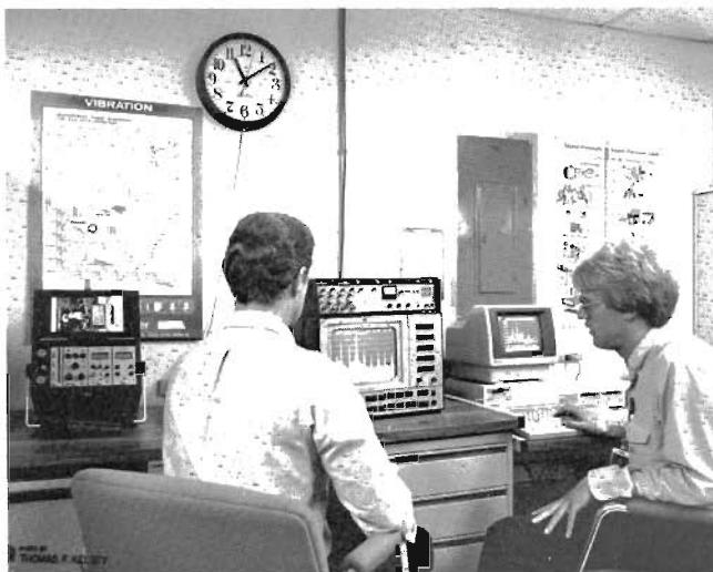
Рис. 3. Лабораторная аппаратура, используемая при проводимом ежемесячно подробном анализе машин, оборудованных мониторизацией
