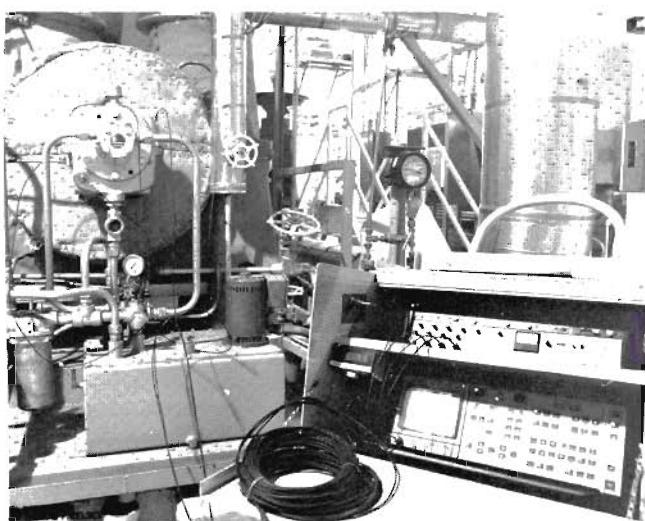
Рис. 5. Запись сигналов, отображающих механические колебания насоса питающей воды парогенератора
