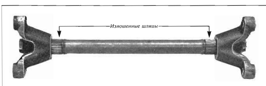
Рис. 16. Приводной вал воздуховодки с поврежденными шлицами
