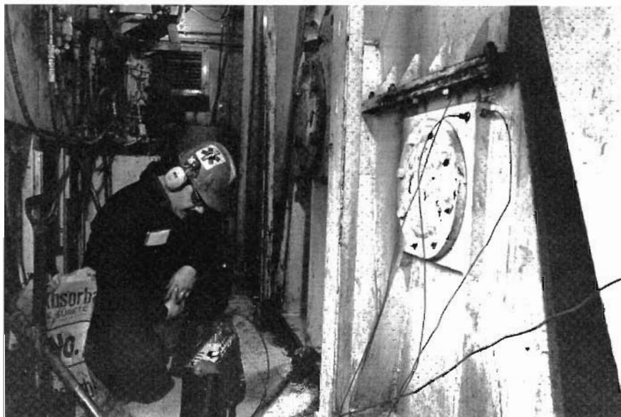
Рис. 11. Магнитная запись механических колебаний трансмиссии привода подъемного механизма. Механические колебания регистрируются в направлениях X, Y и Z
