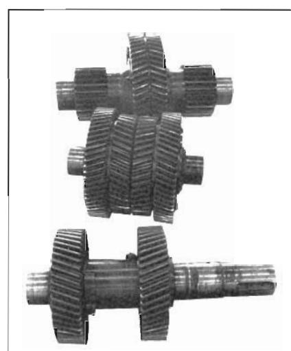
Рис. 21. Шестеренчатые валы экструдера
