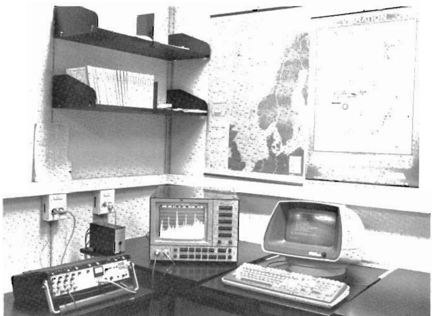
Рис. 2. Терминал ЭВМ и узкополосный анализатор установлены в кабинете инженера, смежном с аппаратной. Печатающее устройство, предусмотренное для распечатки предупредительных сообщений, расположено в аппаратной
