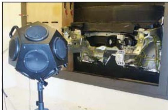
В первую очередь компонент испытывается без шумопоглотителя. Затем добавляется решение Carcoustics. В зависимости от конкретного компонента или узла может выполняться от пяти до тридцати испытаний, после чего результаты сравниваются и анализируются. Шумовые и вибрационные характеристики испытываемого объекта либо определяются Carcoustics на основе огромного опыта, либо указываются клиентом, исходя из итоговых шумовых и вибрационных требований к автомобилю или компоненту.
