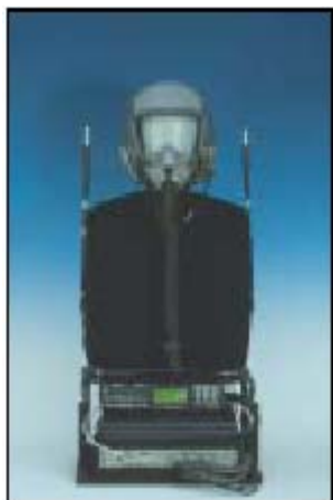
Рис.2 Испытательная установка, включающая НАТС, Мультианализатор PULSE и устройство записи данных SONY® DAT
