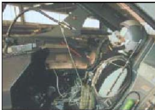
Рис.1 НАТС, полный имитатор со своей отрегулированной системой скелет-голова, установлен в задней кабине F-16.
