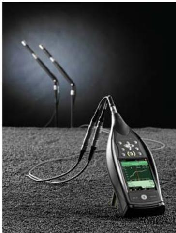
Двухканальное измерение (только для анализатора 2270), которое можно выполнить также просто, как и одноканальное, обладает рядом преимуществ, так как позволяет сократить общее время измерения, получая сигнал сразу от источника и приемника одновременно или сразу в двух точках в одной и той же комнате.
