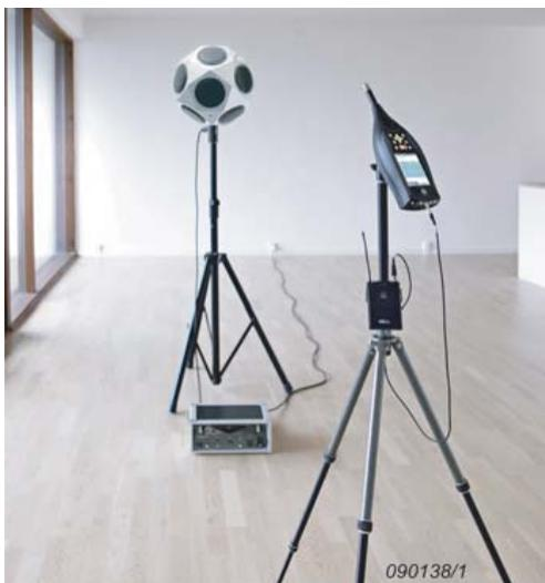
Применение беспроводной аудиосистемы (UL-0256) в полевых условиях позволяет ускорить измерения, сократив количество кабелей, упростив управление усилителем, когда тот находится в другом помещении.
