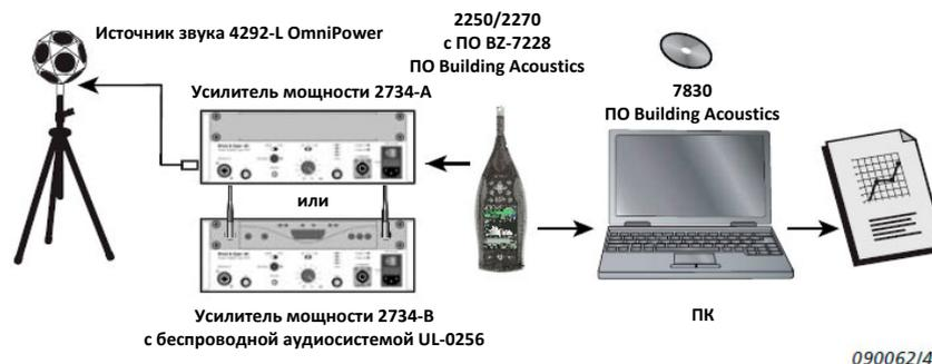
На рис. 2 показана типовая конфигурация наиболее общей задачи по измерению акустики здания: изоляция от воздушного шума.
