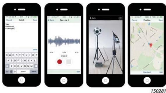
Как только подключение к анализатору будет выполнено, пользователь может начать, прекратить или поставить измерение на паузу дистанционно. В процессе измерения шума на экране приложения LAF показан мгновенный профиль величины LAF. В процессе измерения вибрации на экране отображается быстрый мгновенный профиль.
