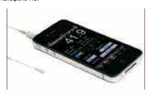
В дозиметре iDosimeter 208 применяется микрофон MPi825, который специально разработан для смартфонов iPhone, обеспечивая качество измерения. Телефон автоматически определяет подключение к микрофону MPi825, когда тот соединяется с ним через разъем наушников. Измерения начинаются при помощи кнопки прикладного программного обеспечения.
