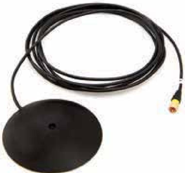
**MPS426** – это недорогой поверхностный микрофон для измерения аэродинамического шума. Он широко применяется в автомобилях и аэрокосмических исследованиях шума, вызванного ветром. Микрофон может быть легко установлен на поверхность при помощи двусторонней липкой ленты.
