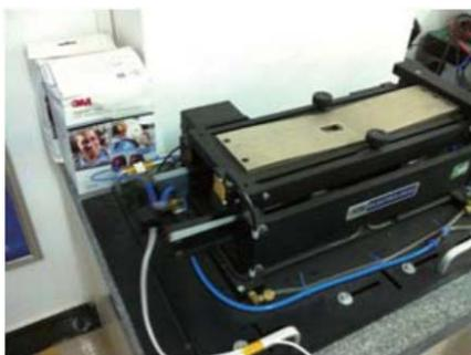
Рисунок 1. Динамический датчик абсолютного давления 113AB, низкая частота от 0,1 до 200 Гц, вибростенд
