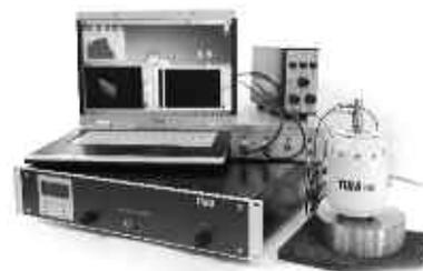
Система позволяет проводить первичную и периодическую поверку (калибровку) следующих типов вибропреобразователей:
