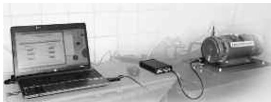
Стенд балансировки роторов
