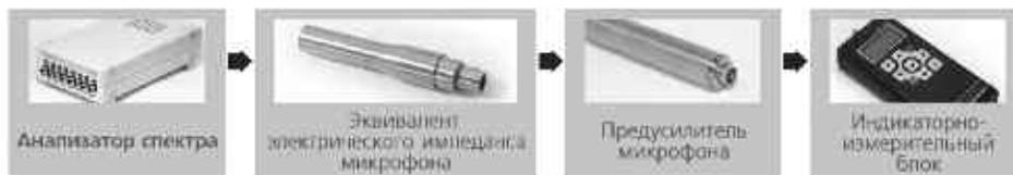
Схема измерений через эквивалент микрофона.
