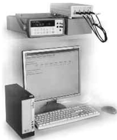
Программа позволяет запускать сплошной контроль параметров, или проводить выборочную проверку. По результатам измерений формируется отчет о поверке по заданной форме. В отчет вносятся полученные значения погрешностей по всем параметрам, предусмотренным методикой поверки, а также вывод о годности прибора, дата проведения поверки и дата следующей поверки.
