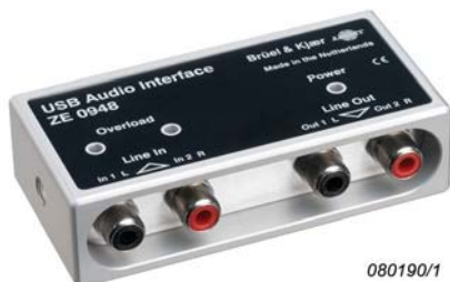
Рис. 11 USB-аудио-интерфейс ZE-0948, рекомендуемый для создания линейного интерфейса подключения микрофона и систем громкоговорителей. Интерфейс ZE-0948 поставляется вместе с ПО DIRAC при заказе с номером 7841-100 (см. п. «Информация для заказа»)
