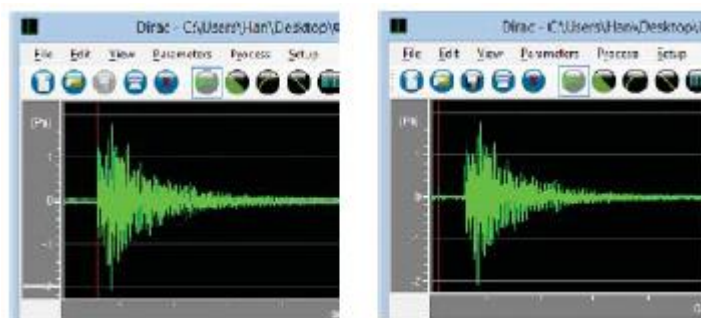
Рисунок 13. Слева: правильное обнаружение фронта импульсной характеристики. Справа: ложный пик, вызывавший ошибочное обнаружение.
