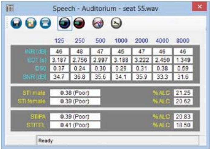
Рисунок 14. Таблица Speech (Речь) с вычисленными параметрами речи
