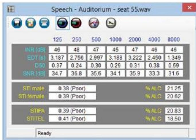
Необходимо заметить, что отношение сигнал/шум (SNR) в этой таблице показывает величину, измеренную в точке расположения микрофона. Для вычисления разборчивости речи отношение сигнал/шум не обязательно, так как ПО DIRAC может изменить уровень сигнала в соответствии с определенным спектром речи таким образом, чтобы нормализовать источник звука.
