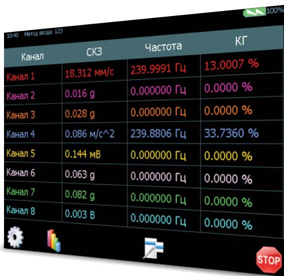
▶ Измерение СКЗ, частоты и КГ
