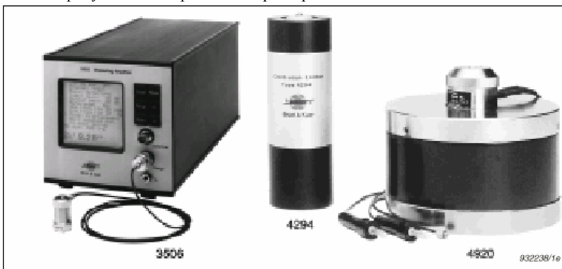
Рис. 14 Оборудование для калибровки базы. Более подробная информация представлена в таблице, содержащей технические данные акселерометров.
