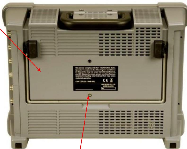
схема пломбировки от несанкционированного доступа
