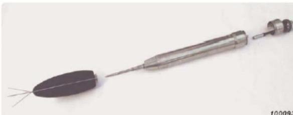
Терминалы, оборудованные всепогодным микрофоном модели 4184-А, становятся пригодными для специального применения, в тех случаях, когда мониторинг требуется в условиях высокой влажности или в присутствии коррозионных веществ, а также тогда, когда пользователь желает использовать дистанционную калибровку при помощи электростатического возбудителя.
