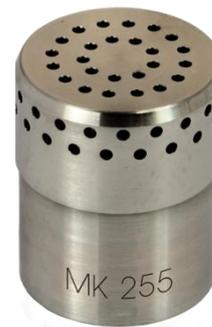
1/2" микрофонный капсюль МК 255 имеет выравненную по свободному полю частотную характеристику и тем самым оптимизирован для корректных акустических измерений в условиях свободного поля с углом падения звуковой волны 0 градусов
