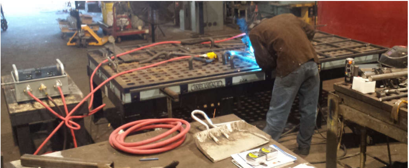
Сварка выполняется непосредственно во время виброобработки.
