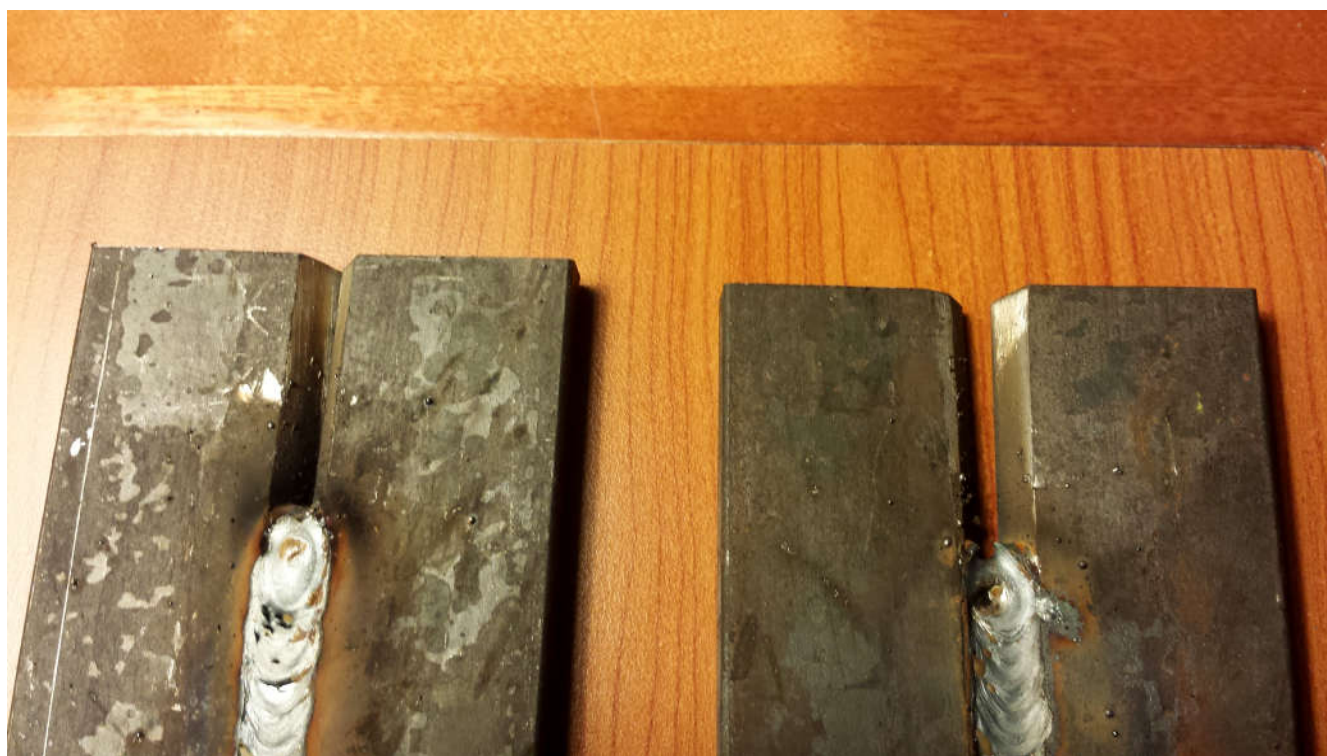
Сварка с вибрацией — слева, без вибрации — справа.
