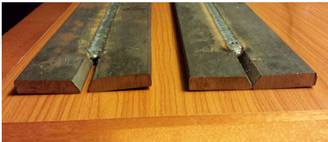
Сварка без вибрации — слева, с вибрацией — справа.
