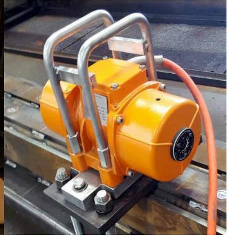
На консоли A-VSR MX-7.5 отображаются точные данные вибрации. На их основе снять остаточные напряжения виброобработкой можно максимально эффективно.
