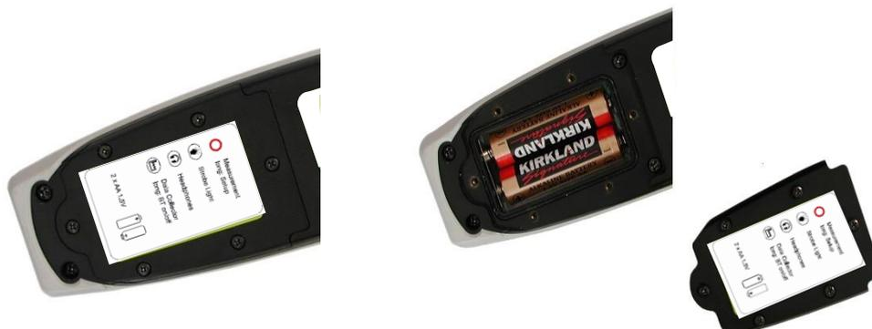
Перед тем, как вставить новые батарейки или полностью заряженные аккумуляторы, вначале нужно вынуть разряженные батарейки. Вставляя батарейки, обеспечьте правильное расположение полюсов, изображенное на крышке батарейного отсека.
