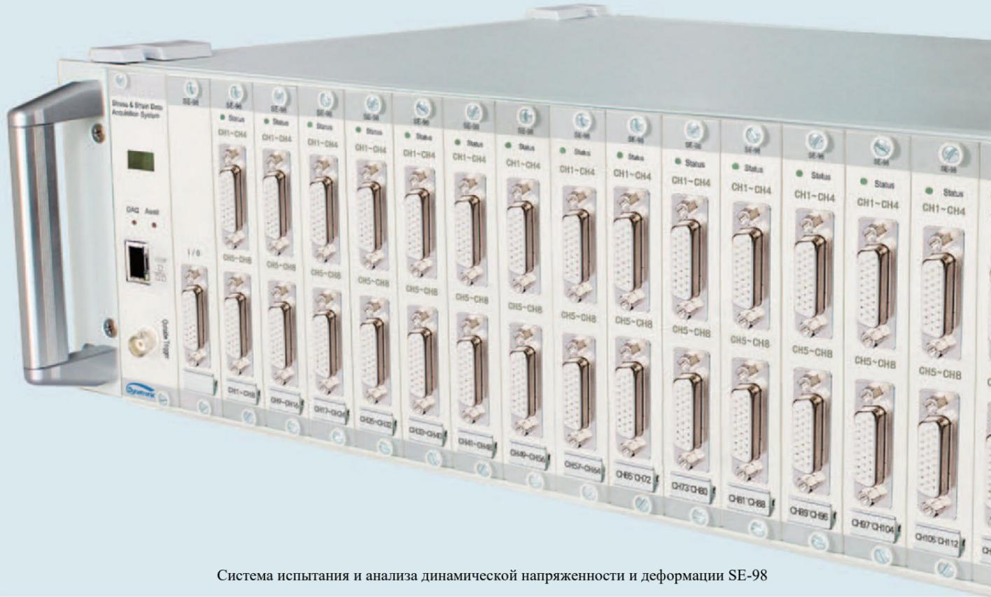
Система испытания и анализа динамической напряженности и деформации SE-98
