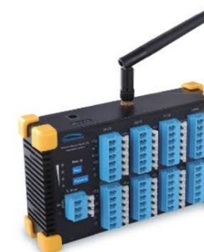
Беспроводная система испытания статической деформации WZ-88S
