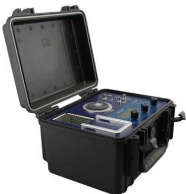
Портативные калибраторы датчиков ECS-1028 предназначены для калибровки чувствительности датчиков ускорения, скорости и перемещения (контактного типа) с частотой до 10 000 Гц в полевых условиях. В калибраторе ECS-1028 используется метод сравнения (последовательного), а автоматическое управление по замкнутому контуру реализовано с помощью встроенного эталонного датчика. Также впервые используется метод поправки кривой чувствительности для повышения точности калибровки.
