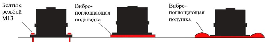
Рисунок 2. Способ монтажа SVT-08.
